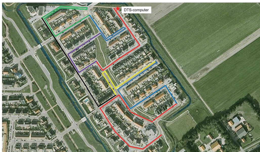
Figuur 2: Tracé DTS-kabel in Polderwijk, in totaal 2800m opgebouwd uit 8 stukken van elk 350m
